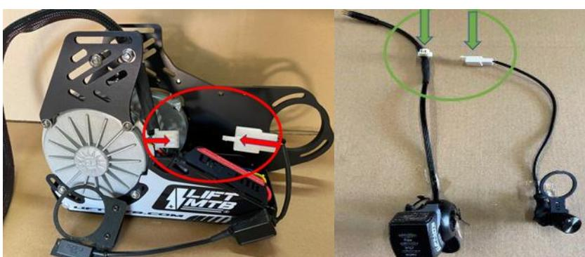
**Pour les modèles avant août 2020** le fonctionnement reste identique, simplement le câblage change pour cela il faudra brancher la connectique du capteur en série sur la connectique gâchette (flèches jaunes sur la photo).
