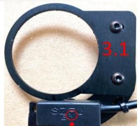
**Advertencia:** La zona donde el sensor detecta el movimiento se encuentra a la altura de la "F" de la escritura "SZFJ" (foto 3.1) esta letra debe colocarse lo más cerca posible del eje, cualquier inversión de posición de un las piezas causarán un mal funcionamiento.
