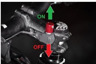
Notez que la gâchette reste toujours prioritaire, c'est à dire que si par exemple le régulateur est sur la position ON, avec le potentiomètre réglé sur 50% de la puissance, et qu'on veut accélérer sans pédaler ou accélérer à fond tout en pédalant c'est possible grâce à la gâchette.
