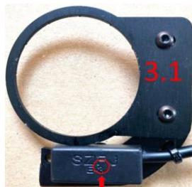
**Attenzione:** La zona dove il sensore rileva il movimento si trova all'altezza della "F" della scritta "SZFJ" (foto 3.1) questa lettera deve essere posta il più vicino possibile all'asse, l'eventuale inversione di posizione di un partì causeranno un malfunzionamento.
