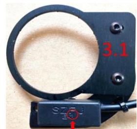
**Attention :** La zone où le capteur détecte le mouvement se situe à la hauteur du "F" de l'écriture "SZFJ" (photo 3.1) cette lettre doit être placé au plus proche de l'axe, toute inversion de position d'un des éléments entraînera un dysfonctionnement.
