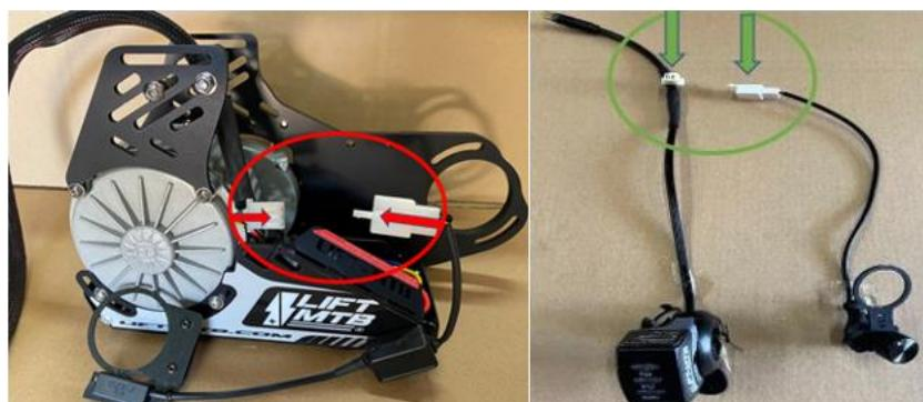
**Per i modelli antecedenti ad agosto 2020 il funzionamento rimane lo stesso, semplicemente cambia il cablaggio per questo sarà necessario collegare il connettore del sensore in serie sul connettore trigger (frecce gialle sulla foto).**
