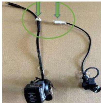
**Pour les modèles avant août 2020 le fonctionnement reste identique, simplement le câblage change pour cela il faudra brancher la connectique du capteur en série sur la connectique gâchette (flèches jaunes sur la photo).**
