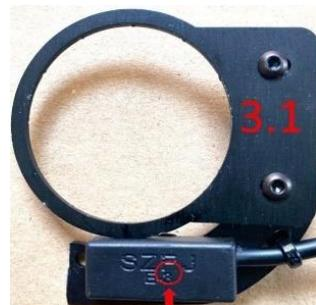
**Attention :** La zone où le capteur détecte le mouvement doit être placé au plus proche possible de l'axe, toute inversion de position d'un des éléments pourrait entraîner un dysfonctionnement.
